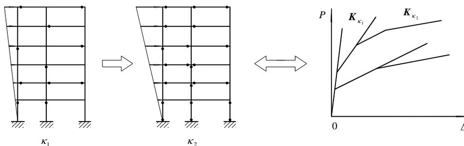
图 3.2 非线性构形状态转移过程示意图
